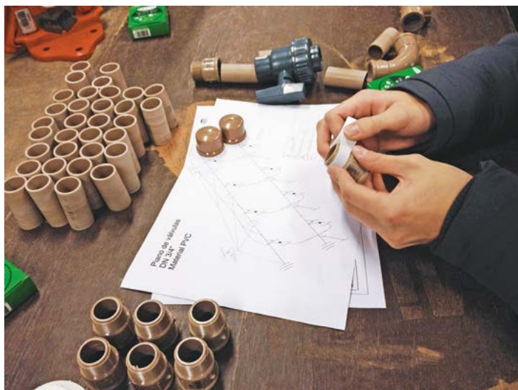
Os estudantes usaram PVC para desenvolver, em escala menor, um mecanismo normalmente produzido em aço
