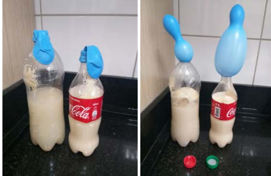
Experiência com os balões inflando devido à produção de gases por meio do processo de fermentação
